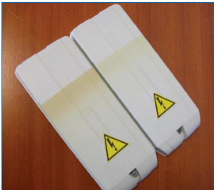
▲ Test comparativo su due coperchi in grigio RAL 7035 dopo una sessione di invecchiamento accelerato
