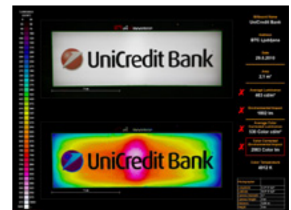
FIGURA: cassetto: si noti la variabilità della luminanza dal centro al bordo (Courtesy of Andrej Mohar)
