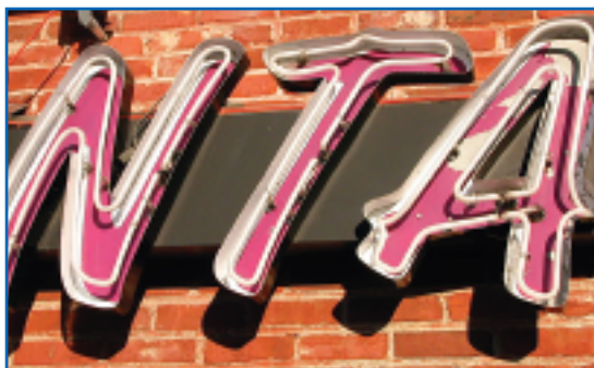
◀ Figura 2: Si noti annerimento in prossimità degli elettrodi della lettera A
