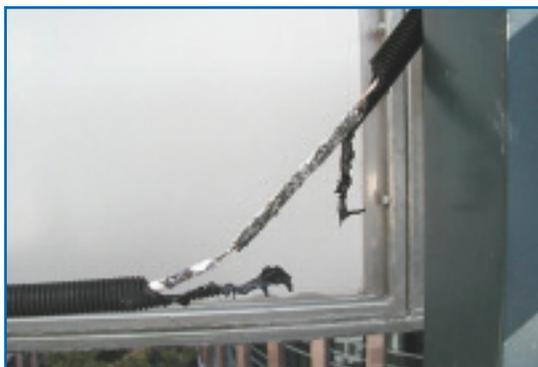
▲ Particolare in cui si nota come la corrosione abbia intaccato sia la guaina, sia l'isolante del cavo
